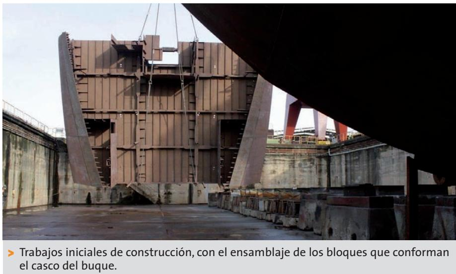
> Trabajos iniciales de construcción, con el ensamblaje de los bloques que conforman el casco del buque.
