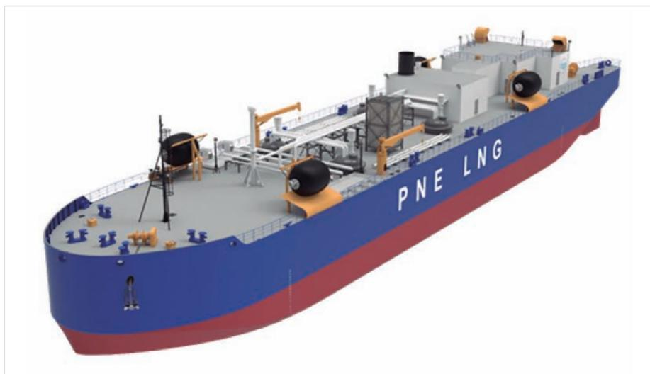
➤ La barcaza norteamericana “Clean Canaveral” cargará hasta 5.400 m<sup>3</sup> de GNL. En su diseño destacan las defensas laterales y el encaje practicado a popa donde se aloja la proa del remolcador que la propulsa y maniobra.
