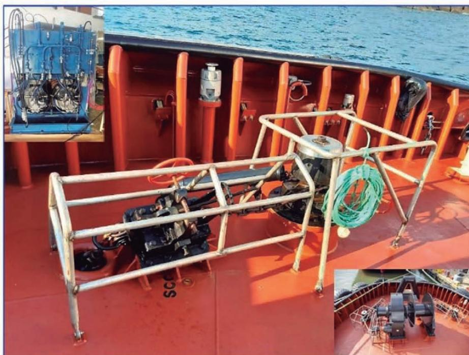
Dos de los grupos actúan en el giro del equipo y el tercer grupo es un grupo auxiliar que garantiza el arriado de emergencia y las funciones auxiliares incluso sin disponer de alimentación eléctrica, al contar con un acumulador que ofrece un mínimo de 6 operaciones completas de apertura de frenos.
