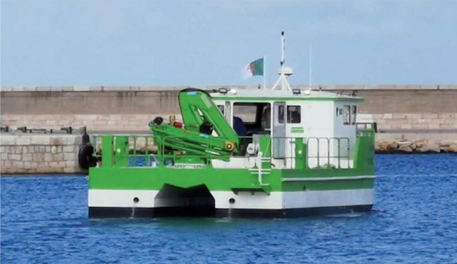
➤ Desde la popa del nuevo buque de Blachadell se aprecian la grúa y la forma del túnel adoptada entre los cascos para amortiguar el impacto de la ola bajo el buque.
