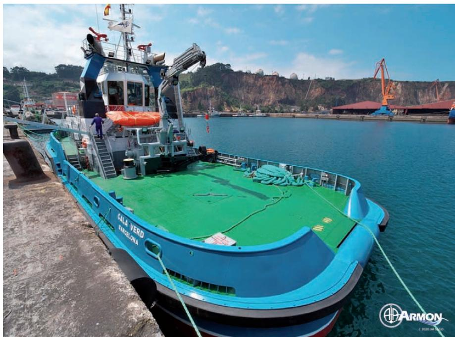
> Despejada cubierta de popa del “Cala Verd”. Sobrevolando la maquinilla y a popa de la embarcación auxiliar, se levanta la grúa de Cytecma que emplea el remolcador.
