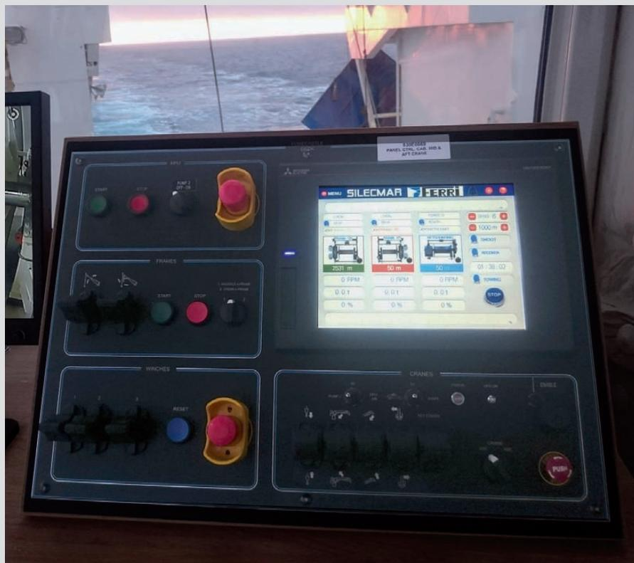
➤ Los sistemas Silecred de Silecmar, S.L., permiten la visualización y el control automático de las maniobras en las que intervienen maquinillas de cable. El sistema es de aplicación directa en cualquier tipología de buque (arrastre, cerco/atunero, remolque,...), en cualquier tipo de maquinilla y controlando cualquier tipo de sistema de accionamiento, ya sea hidráulico o eléctrico.
