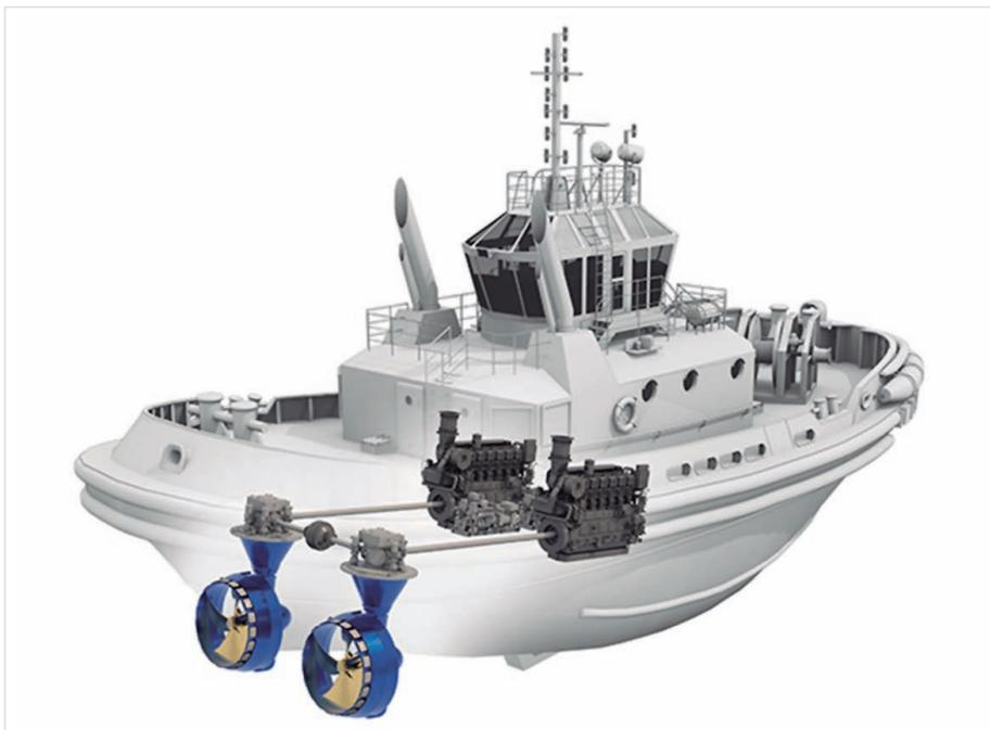
➤ Esquema de la disposición de la propulsión SYDRIVE-M de Schottel que empleará el remolcador.
