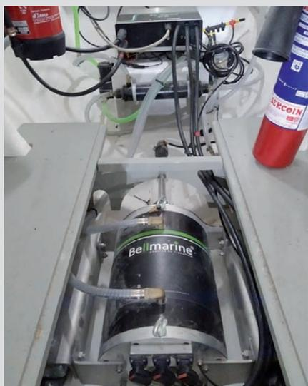
> Motor eléctrico Bell Marine instalado en el "Eko Kat" y proporcionado por Azimut Marine.
