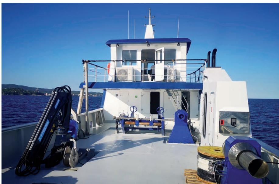
> La amplia y despejada cubierta del buque dispone de la maquinaria para trabajar con hasta cuatro modalidades de pesca. Destaca la balconada abierta sobre el parque de pesca desde donde profesores y alumnos pueden observar el trabajo de sus compañeros, con el funcionamiento de los diferentes artes y sus equipos.
