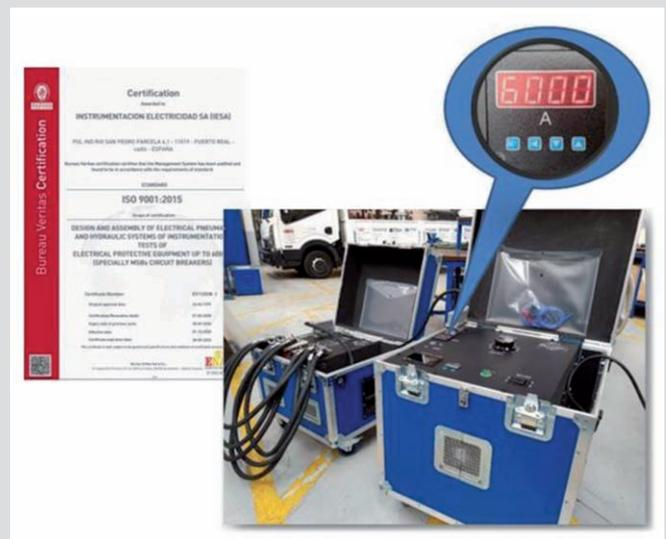
> Equipos portátiles de IESA para comprobaciones de los interruptores automáticos principales de la planta eléctrica del buque (Circuit Breaker Test), acompañados por la certificación de Bureau Veritas.
