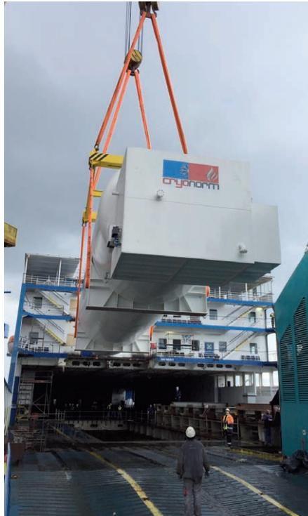
➤ El tanque de GNL, suspendido sobre las cubiertas del “Sicilia” en el momento de su implantación a bordo.
