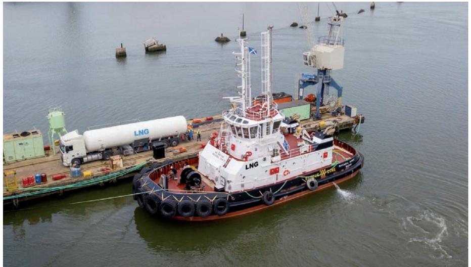
> Primera operación de bunkering de GNL del remolcador, realizada por Molgás, sistema TTS.
