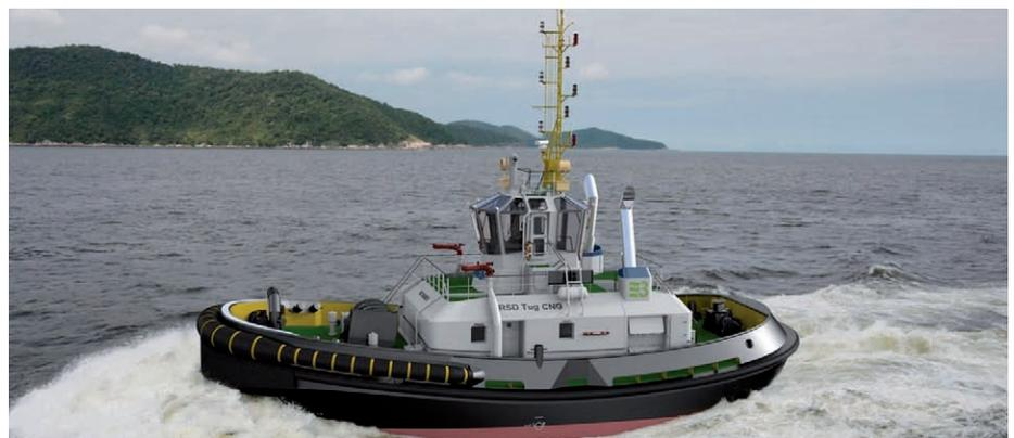
> “Una alternativa al GNL como combustible fue lanzada conjuntamente desde los astilleros holandeses Damen Shipyards, el fabricante de motores MTU y la armadora Svitzer en 2016. Construyeron y botaron el prototipo “Tug 2513”, propulsado con Gas Natural Comprimido (CNG) que movía motores MTU de la serie 4000 M63. El buque realizó una serie de visitas promocionales a puertos europeos, entre ellos los de Barcelona, Tarragona, Valencia, Algeciras y Bilbao.
