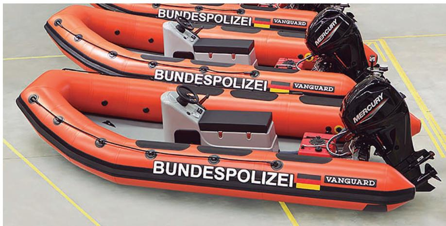
➤ Lanchas de Vanguard para la Policía Federal alemana, equipadas con un motor Mercury de 40 CV (Foto cortesía de Vanguard Marine.)
