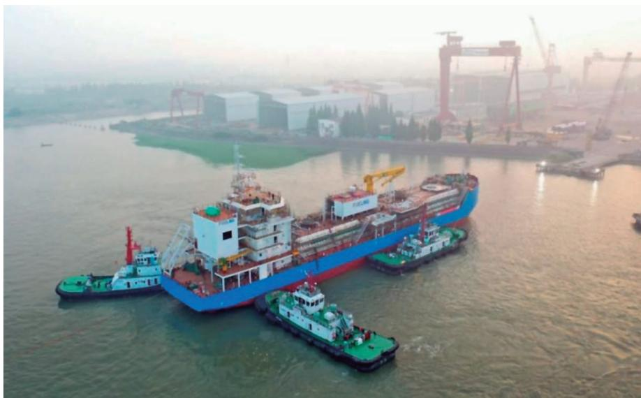
➤ El buque de bunkering que se completa para Singapur tiene una velocidad de llenado de hasta 1.000 m<sup>3</sup> de GNL por hora y puede abastecer a muy variados tipos de buque, con alturas de bandas al costado que oscilen entre 3 y los 23 metros sobre la línea de flotación.
