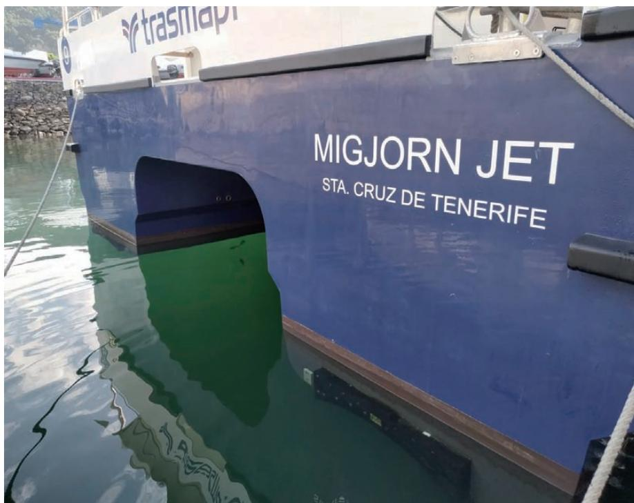
> La popa sumergida de los cascos muestra la presencia del sistema de interceptores horizontales de Humphree para la mejor estabilización.
