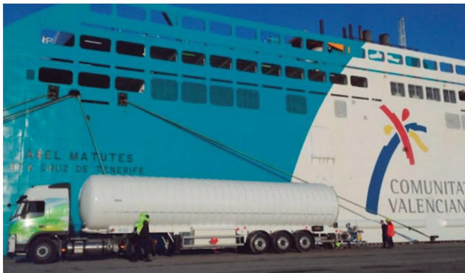
➤ Los puertos se dotarán de un reglamento específico para el suministro de GNL a los buques. En la imagen, operación de bunkering de gas natural licuado al “Abel Matutes” en el puerto de Barcelona.
