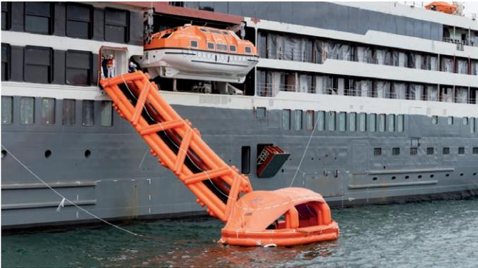
➤ Despliegue de una de las rampas de evacuación que enlaza con la balsa a flote en caso de emergencia.
