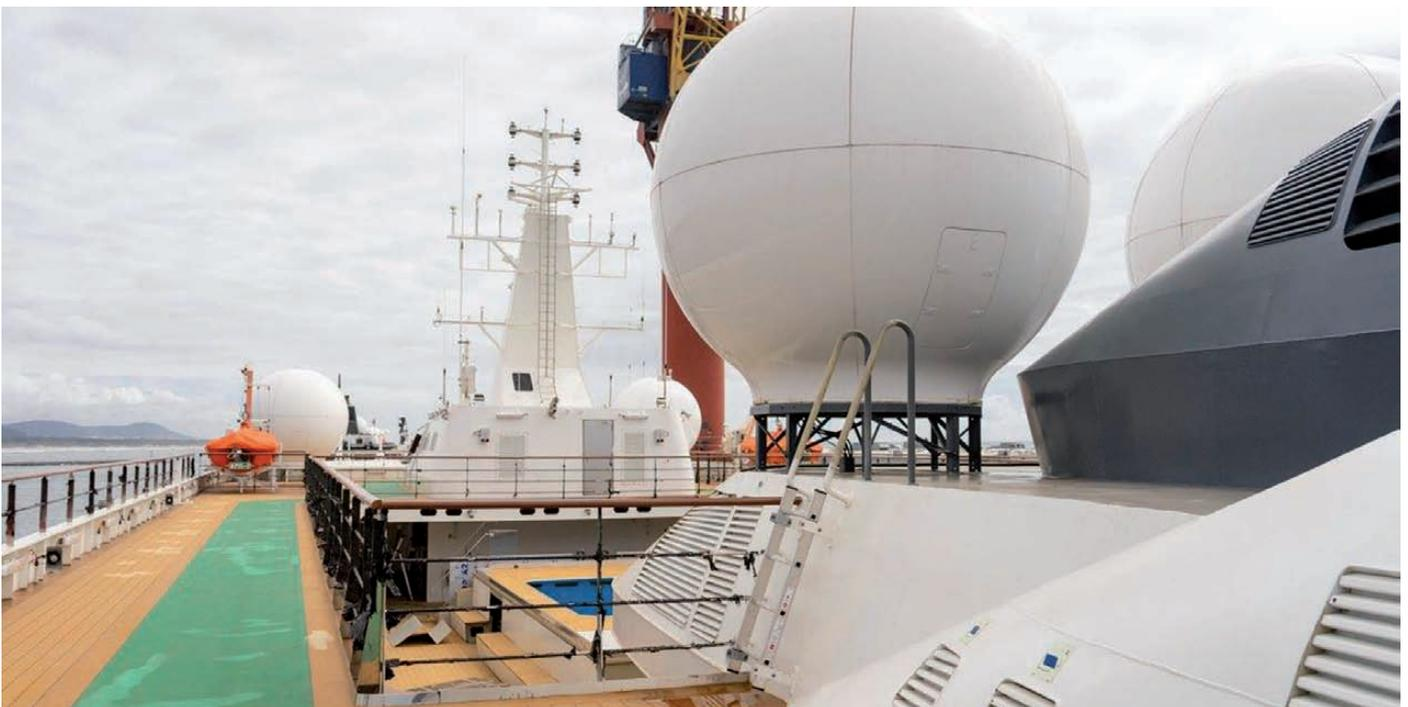
➤ Equipos de comunicaciones y antenas desplegados en la cubierta superior.
