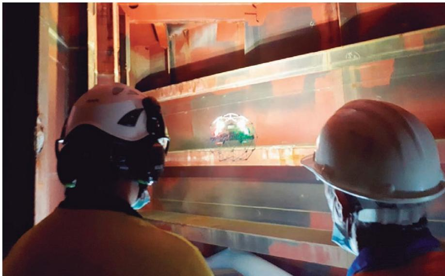
➤ Operarios de Dronexservices mueven un dron en el interior de un buque.
