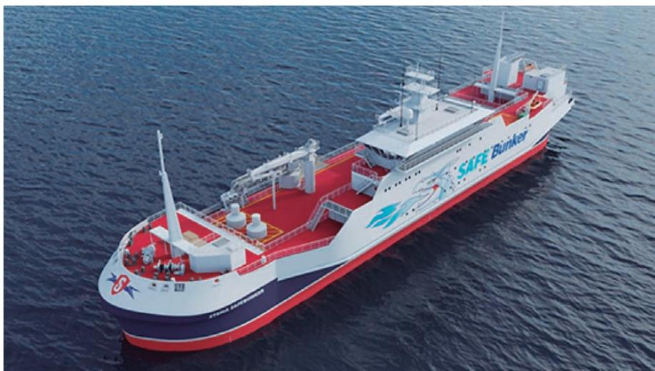
➤ Un buque de bunkering especialmente diseñado para minimizar los contactos físicos con los buques a los que atiende, sobre todo ante los posibles impactos de banda contra banda.
