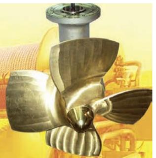
La hélice es una CPP Schottel en tobera de cuatro palas, con 4.000 mm de diámetro, acompañada de un timón de Becker (Flap Type) suministrado por Aries. En proa, el arrastrero lleva una hélice de maniobra Schottel, del tipo STT1FP de 400 kW.
