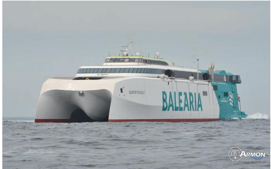
➤ Las afiladas proas cortan limpiamente el agua sin apenas levantar espuma y sin crear ondas laterales.
