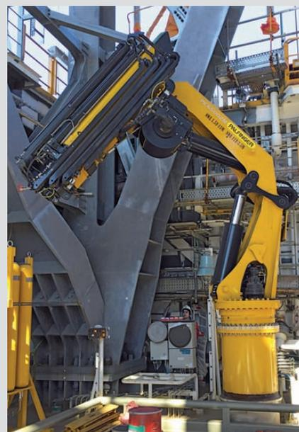
➤ La grúa Palfinger Marine PK 33002M F, configurada especialmente para la nueva planta de Enagás en Huelva y montada por Millecasa, es capaz de cargar 900 Kg a 17 metros de alcance e incluso logra los 18,80 metros. Cuenta con unidad hidráulica, Power Pack independiente y mando a distancia, todos sujetos a la Directiva ATEX (2014/34/EU) para la industria. Palfinger Marine es proveedor experimentado en proyectos ATEX (Aparatos destinados a ser empleados en Atmósferas Explosivas).
