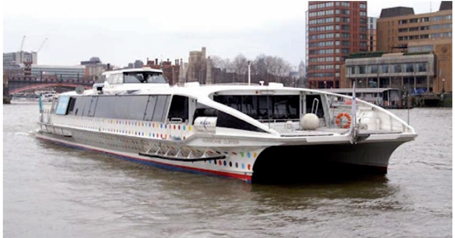
> Desde el año 2019, el “Hurricane Clipper” ha estado operando en el río Támesis y cumple con el nivel III de la OMI. propulsado por motores V12 de MAN Engines.
