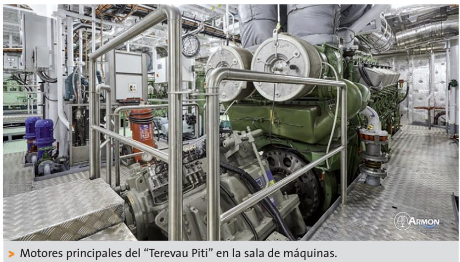
> Motores principales del “Terevau Piti” en la sala de máquinas.
