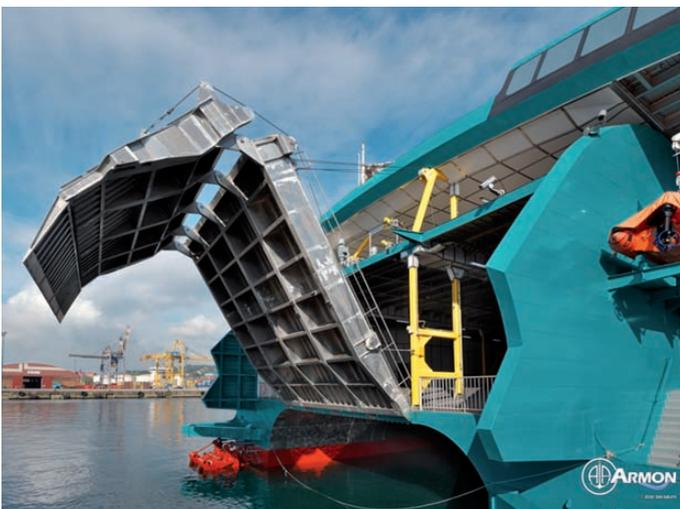
> Rampa de popa accionada hidráulicamente.
