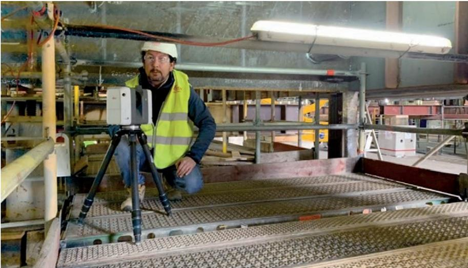
➤ Toma de datos en astillero con el sistema RTC360 de Leica. Se trata de un escáner láser 3D de alto rendimiento que se complementa con la aplicación para dispositivo móvil Leica Cyclone FIELD 360 y que registra automáticamente los escaneos en tiempo real.
