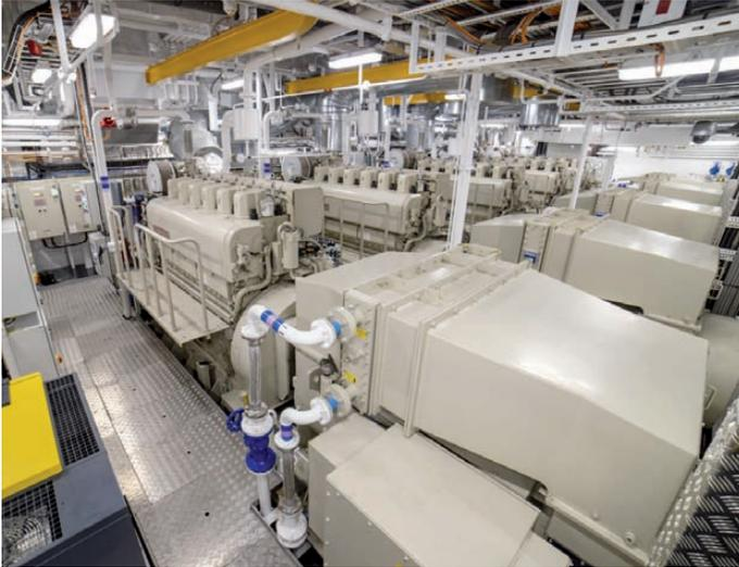
> Perspectiva de la sala de máquinas con los cinco motores generadores Yanmar y sus correspondientes alternadores.
