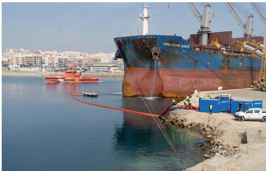
➤ Ejercicio de despliegue de una de las barreras de contención de Grintec en torno a un buque granelero, simulando un vertido accidental y su respuesta.
