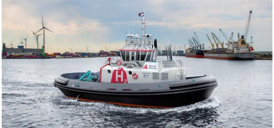
> Bajo el nombre comercial de BeHydro, el primer motor de ABC con hidrógeno equipará el remolcador “Hydro Tug”, montando dos motores tipo 12 VDZD- Dual Fuel de 2 MW cada uno, con un Volvo Penta Tier III como auxiliar.
