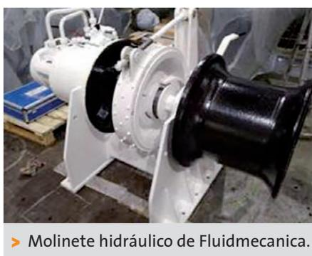
> Molinete hidráulico de Fluidmecánica.
