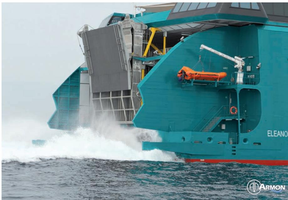
➤ Estructura de popa, con la rampa en navegación y el bote auxiliar con su pescante de maniobra.
