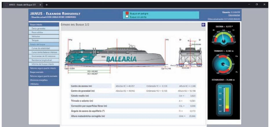
➤ Pantalla del sistema Janus donde se muestran los datos de estabilidad, trimado, escora y reparto de la estiba, entre otros parámetros imprescindibles en la operación completa del buque.
