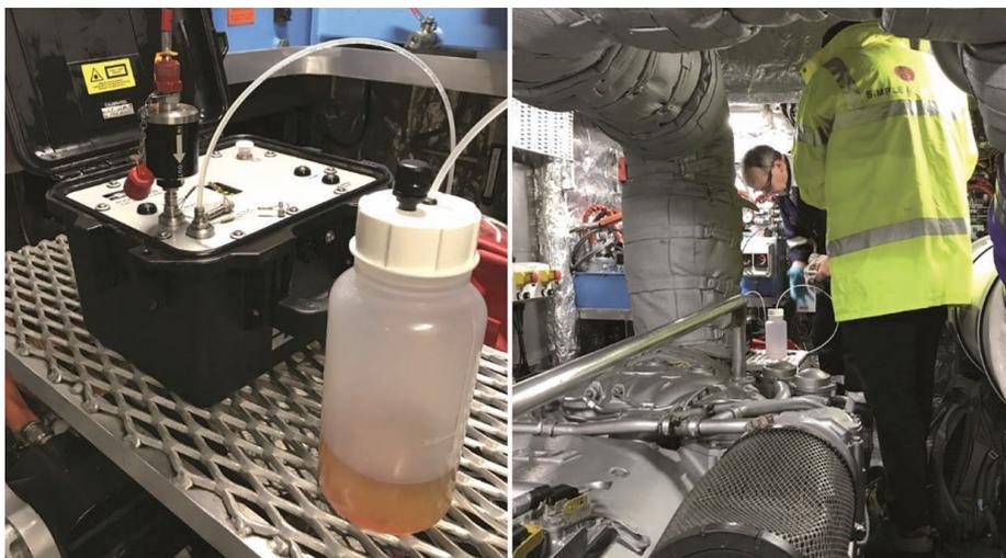
> Equipo de monitoreo Parker iCount Oil Sampler, durante la realización de una prueba a bordo de un ferry para analizar la calidad del aceite hidráulico utilizado.
