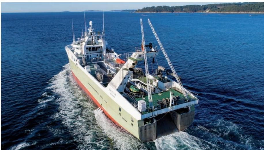
> Parque de pesca del “Falcon”, bajo cuya cubierta se extiende la planta de procesado. Las dos largas pértigas que emergen de la popa son las encargadas de sostener el sistema de líneas para pájaros en el momento del virado de la red.
