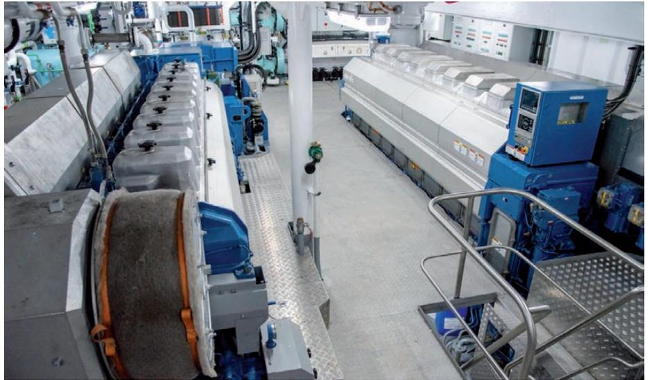
➤ Máquina principal y planta generadora de Wärtsilä a bordo del “Falcon”.
