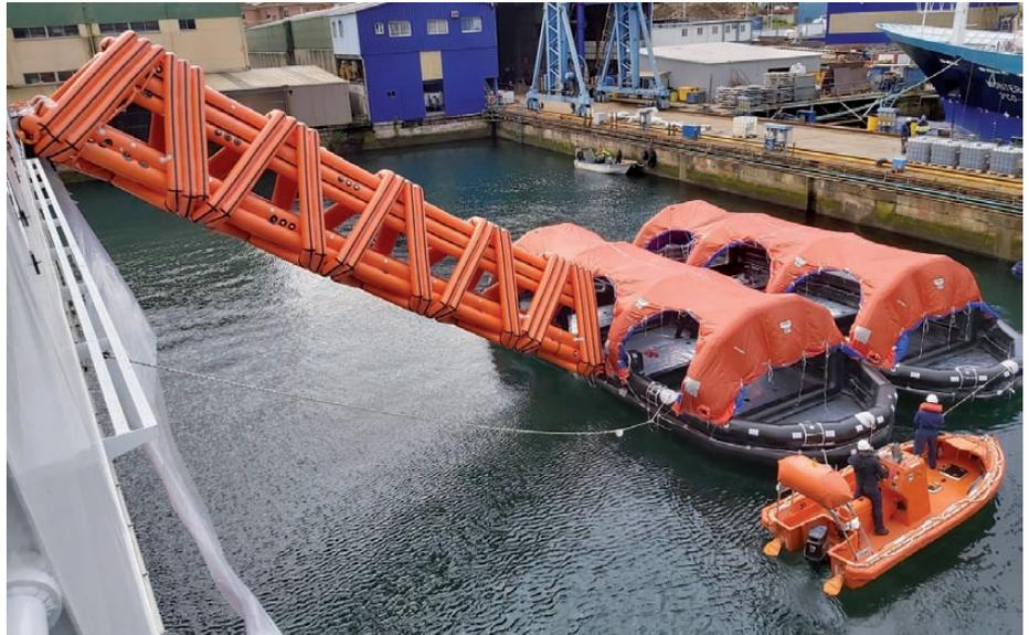
> Pruebas de despliegue del sistema de evacuación del ferry hasta las balsas de salvamento.
