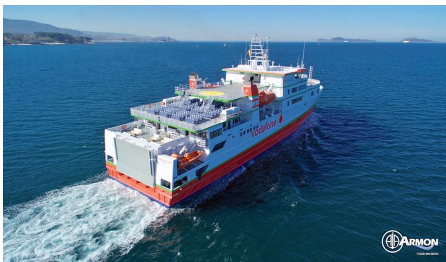
> El “Terevau Piti” en pruebas en aguas de Galicia, antes de viajar a las antípodas. Destaca la amplia terraza de butacas y la zona destinada a evacuaciones aéreas mediante grúa de helicóptero (Only Winch) marcada por el círculo amarillo.
