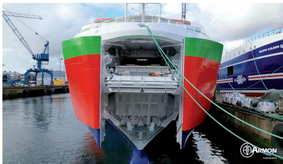
➤ La compuerta y la rampa de proa facilita el embarque de las cargas rodadas.
