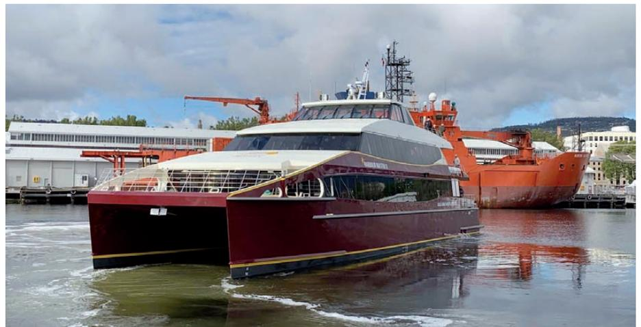
➤ El “Harbour Master II”, botado en octubre de 2020, fue diseñado por la australiana Incat Crowther y se distingue por la eficiencia y el mínimo impacto ambiental de sus operaciones. Alcanza los 28 nudos gracias a los cuatro Doen DJ200 waterjets, accionados por cuatro motores Scania DI16 076M.
