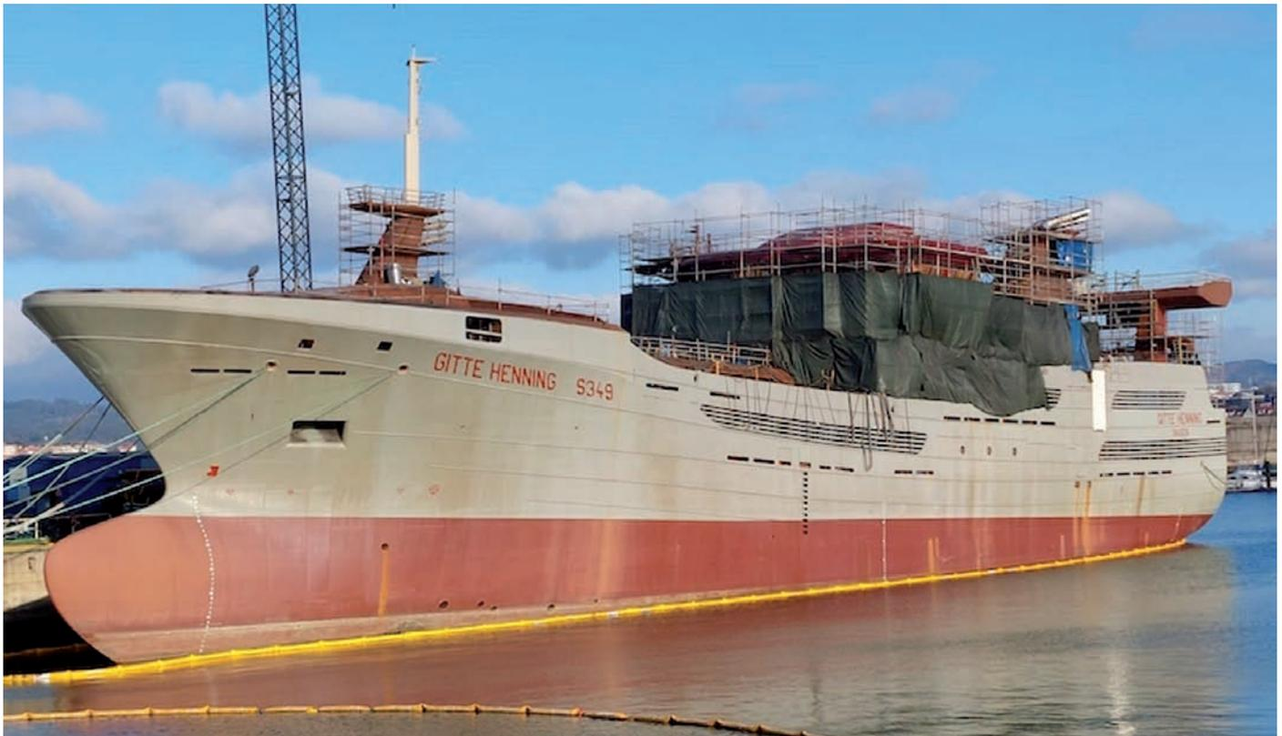
➤ Con 87,65 m de eslora y 20 m de manga, la capacidad de almacenamiento de pescado en el arrastrero de Zamakona es de 3.700 metros cúbicos en tanques RSW (refrigerados con agua salada). Bureau Veritas ha clasificado al “Gitte Henning” con la Notación: Fishing vessel, I Hull ⌘ Machinery ⌘ Unrestricted navigation, AUT-UMS ⌘ ICE CLASS ID, MON-SHAFT.
