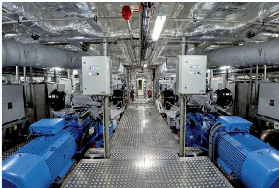
> La sala de máquinas se extiende por la eslora del buque, alojando los sistemas híbridos de propulsión.
