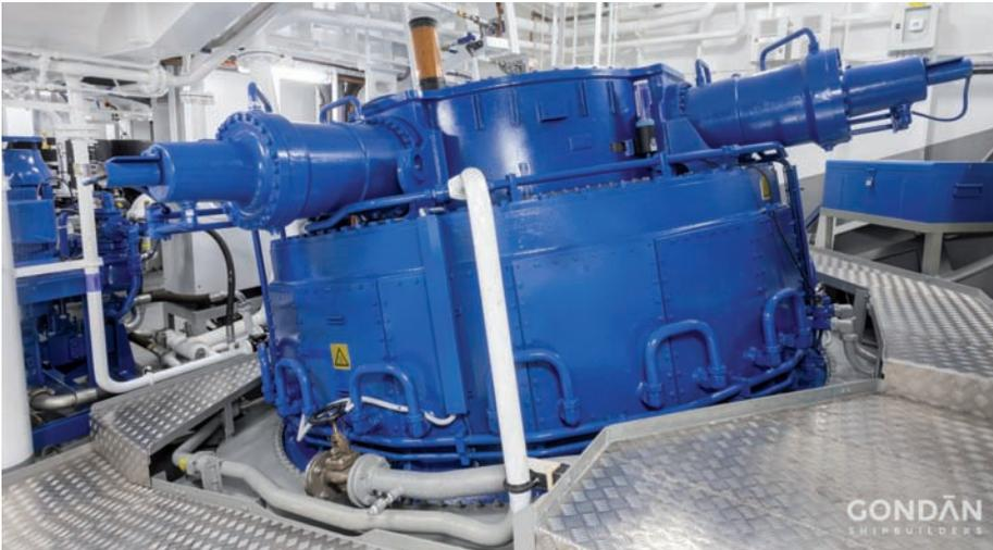
> Maquinaria interior de uno de los propulsores cicloideales Voith Schneider, sistema altamente maniobrable capaz de cambiar la dirección del empuje de forma casi instantánea.
