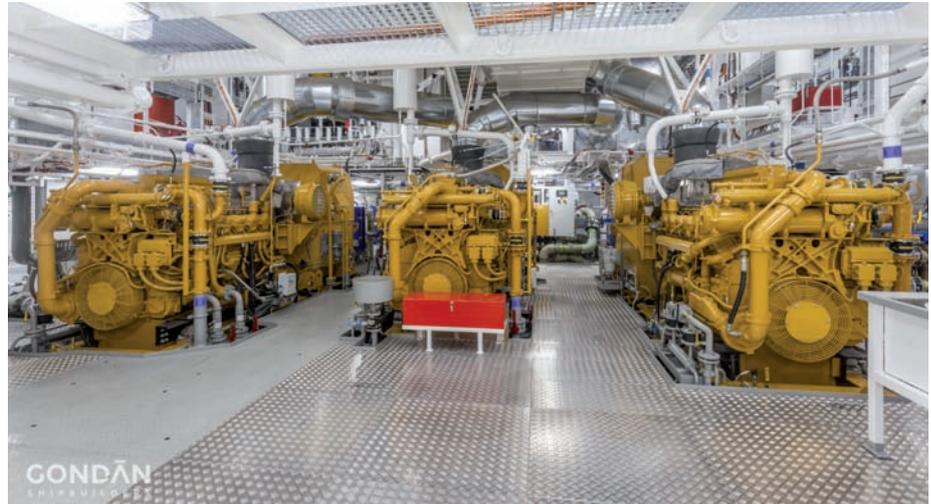
> Los tres motores Caterpillar que integran el sistema de propulsión BlueDrive de Siemens en el CSOV.
