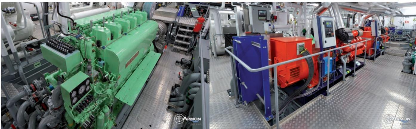
> Dos imágenes de la sala de máquinas del “Destiny” con el motor principal Yanmar y los grupos generadores Scania.
