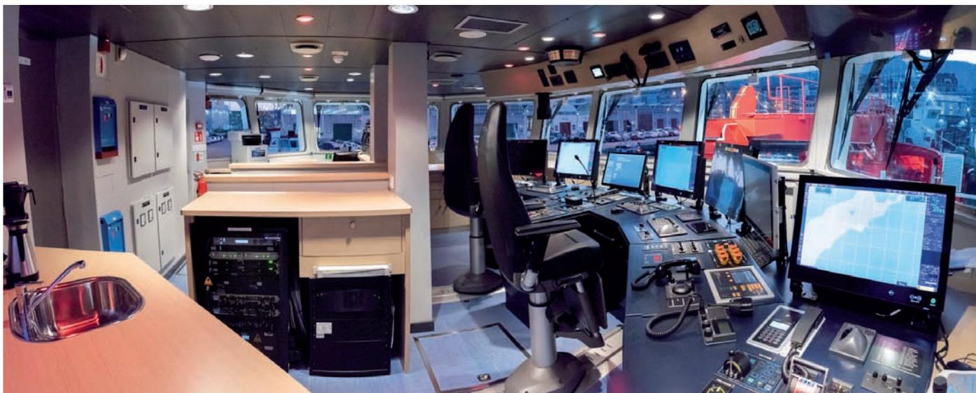
➤ Puente de navegación y comunicaciones del “Arpaarti Arctica”. El buque está clasificado para navegación polar Clase 7. Acco Trade aportó dos sillas de piloto de la marca Alu Design, modelo Altutech 630. Son asientos ergonómicos con respaldo reclinable, regulación neumática del asiento en altura, reposapiés y brazos ajustables.
