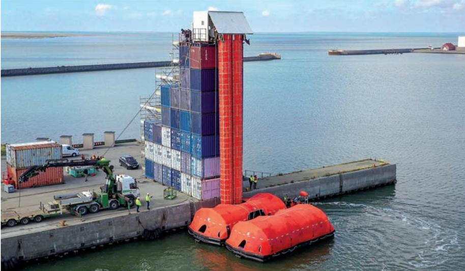
> Prueba del sistema VEDS en puerto, mediante estructura que simula el costado de un gran buque.
