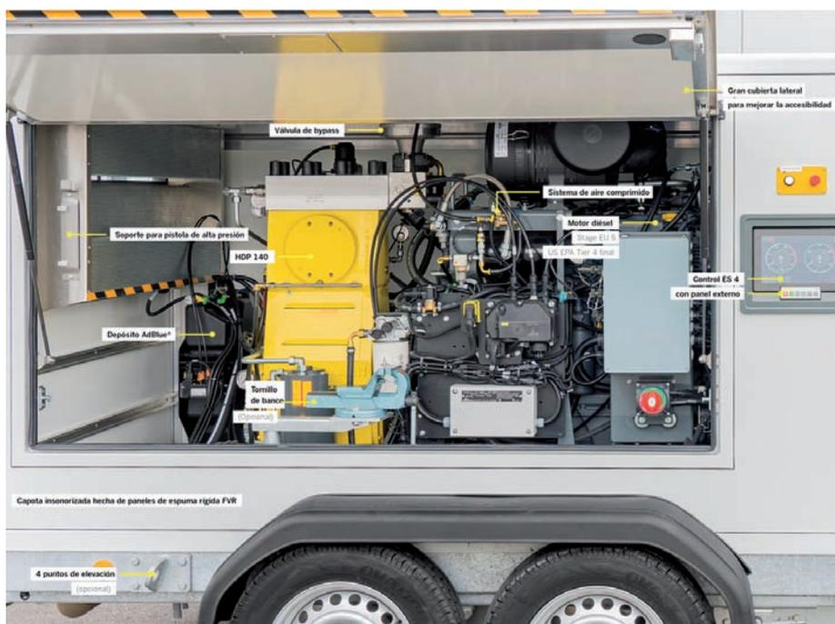
➤ Aquajet 140. El corazón de la serie Aquajet 140 es la bomba de alta presión de 3 pistones HDP 140. La unidad se acciona por un robusto motor diésel industrial de marcas reconocidas. El sistema aporta innumerables ventajas y está disponible en diferentes versiones y niveles de rendimiento. ¡Encontrarás el equipo más adecuado para tus aplicaciones!
