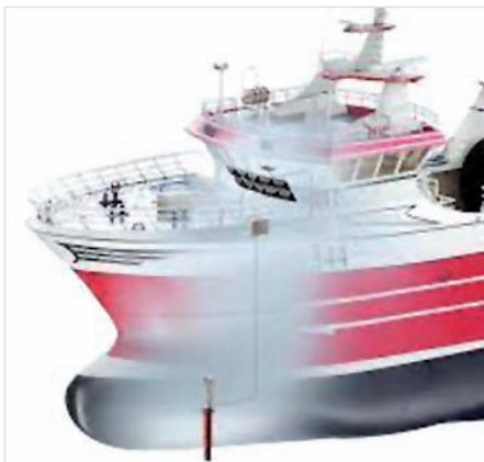
> Un único cable Ethernet conecta el ordenador en el puente a la fuente de alimentación y al transductor en la sala del sonar.
