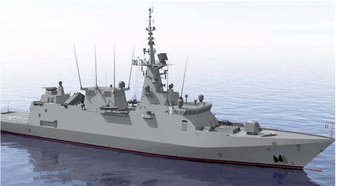
> Imagen virtual de las corbetas de la Clase Avante 2200 Combatant de Navantia, con la herramienta de diseño Foran de Sener Marine.
