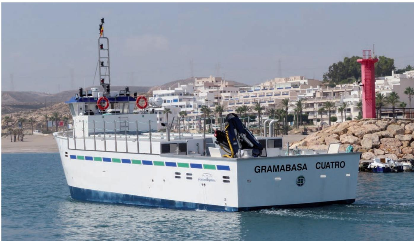
► El modelo del “Gramabasa Cuatro” tiene 24 metros de eslora y 7 metros de manga, distribuidos con un puente en proa y toda la superficie por encima de los silos disponible como superficie continua.
