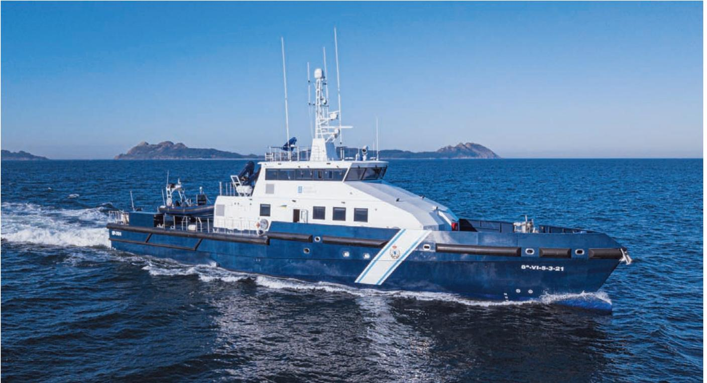
➤ Un buque moldeado en PRFV enteramente diseñado y construido en Vigo.
