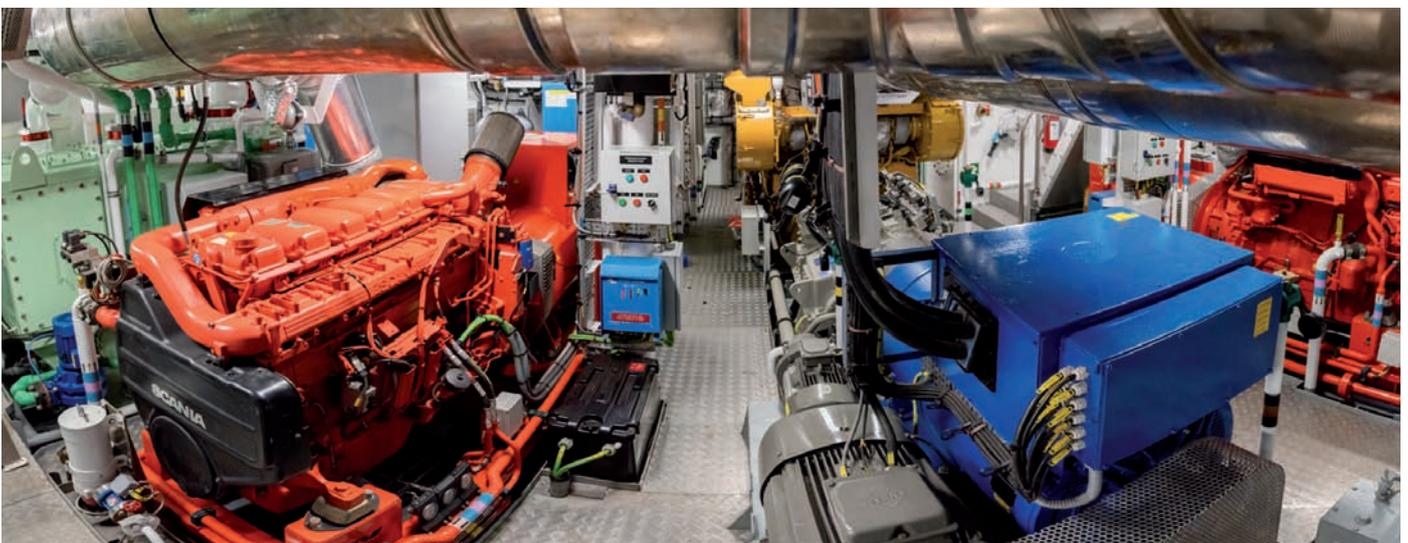
> La máquina principal, en el centro de la imagen, flanqueada por los generadores Scania.
