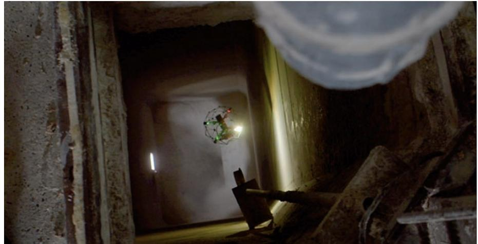
➤ Un dron del tipo Elios 2 volando en interior de un depósito de almacenamiento en una planta industrial.
