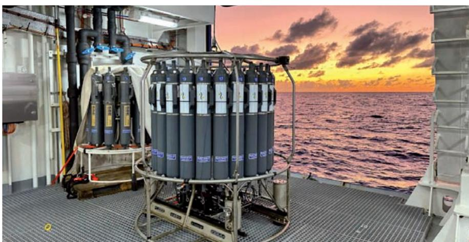
➤ Hangar mostrando un sistema Sea-Bird Electronics 911plus y 24 botellas Niskin de 12 litros de capacidad.
