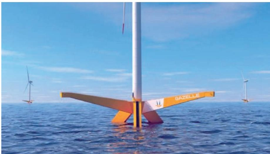
> Aspecto exterior del sistema Gazelle de soporte flotante para aerogeneradores destinados a operar en aguas profundas.
