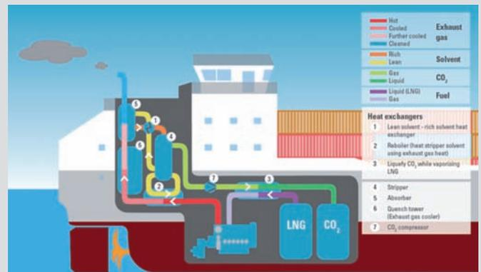
➤ Esquema general de una planta OCCUS como la instalada en la draga movida con GNL “Ecodelta”. El proyecto, denominado CO2ASTS (CO<sub>2</sub> Capture, Storage and Transfer in Shipping), obtuvo financiación del programa europeo Interreg (Alemania – Holanda).
