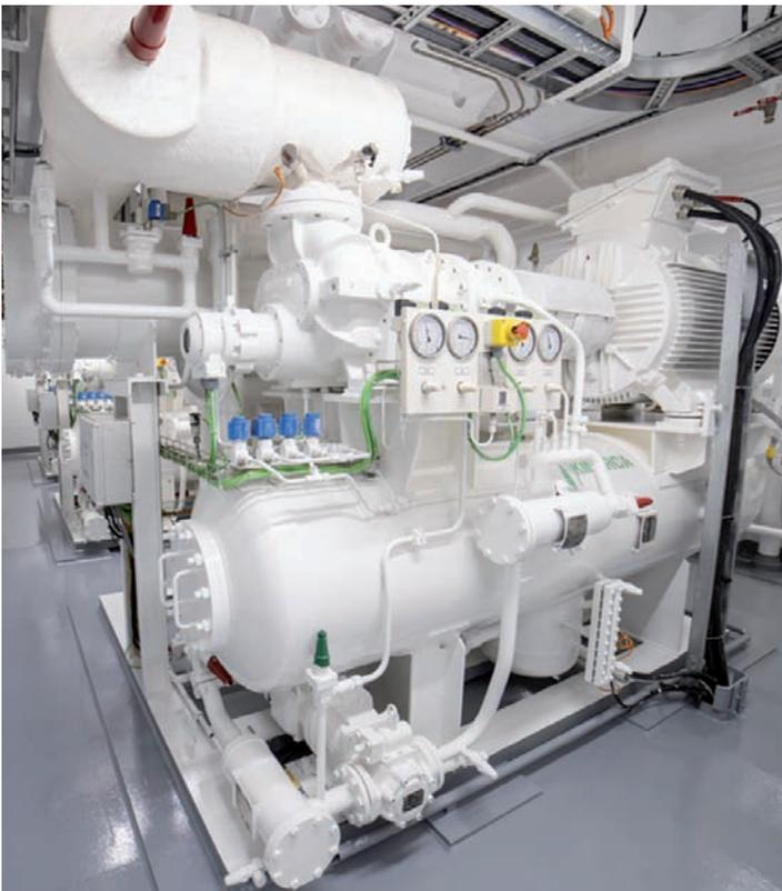
> Equipos compresores Kinarca para la planta de frío del buque.
