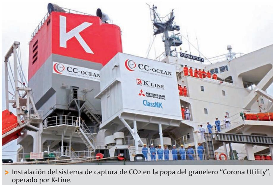
➤ Instalación del sistema de captura de CO2 en la popa del granelero “Corona Utility”, operado por K-Line.
