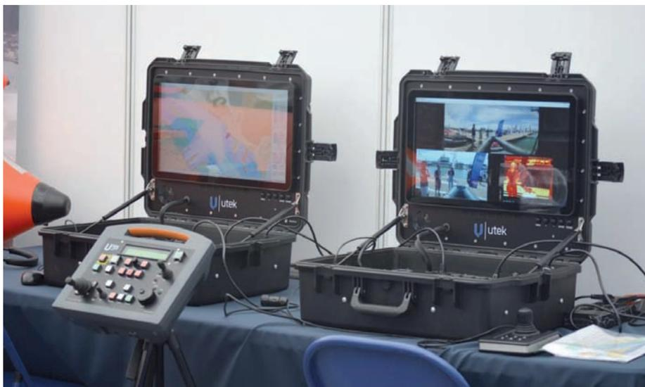
> Estación de control del USV Kunai de Utek, fácilmente transportable.
