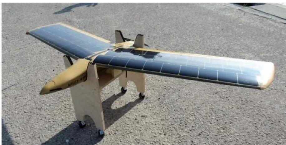
➤ El dron Airfox de Marine Instruments es alimentado con energía fotovoltaica.
