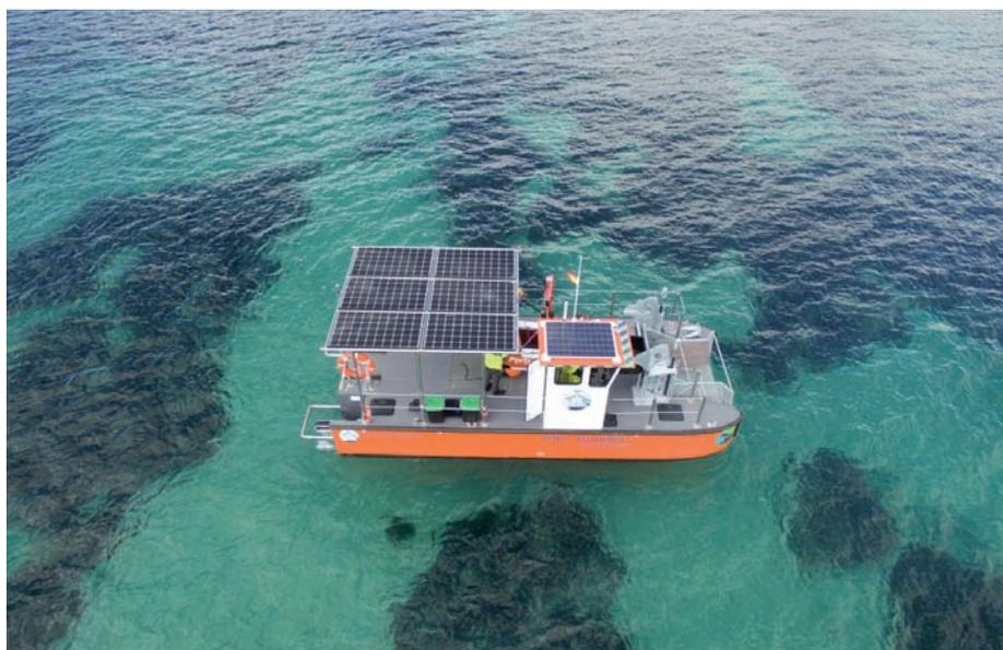
> Uno de los catamaranes de casco semirígido CatClean85, desplegados en 2020 en los puertos de Ibiza y La Sabina (Formentera), empleando baterías de Endurance Motive para acumular la energía fotovoltaica generada a bordo.
