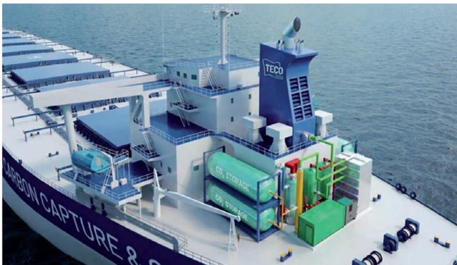
➤ Posible montaje de la planta de OCCUS diseñada por TECO en la popa un buque, adosada al guardacalor y con la ubicación lateral de los tanques de almacenamiento del CO2 capturado.
