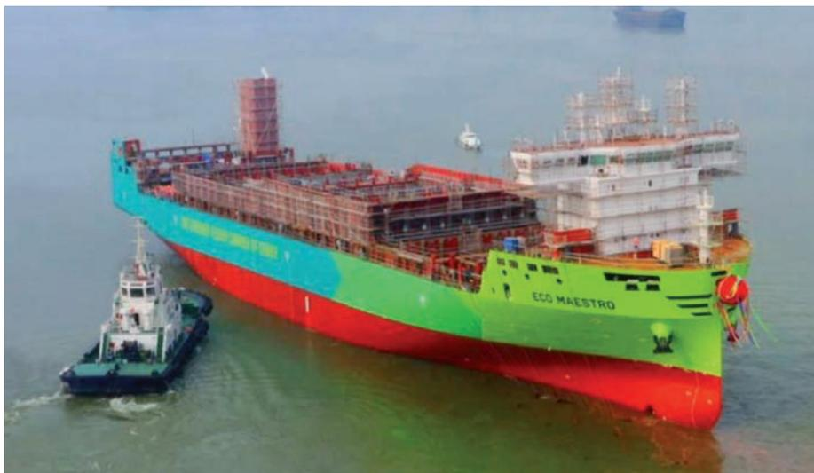
> Diseñado por la ingeniería alemana Technolog Servies GmbH, el “Eco Maestro” tiene una capacidad de 950 TEUs, con 148 metros de eslora y manga de 27 metros. El nuevo “Eco Maestro” se equipa con los más recientes motores DF de MAN para utilizar metanol. Dispone de la última tecnología en generadores de eje y hélices ajustables.
