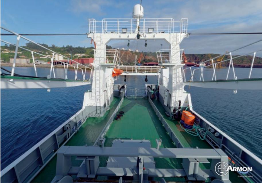
> Pórtico de Hidramarin, con el VSAT para internet por el bienestar de la tripulación.
