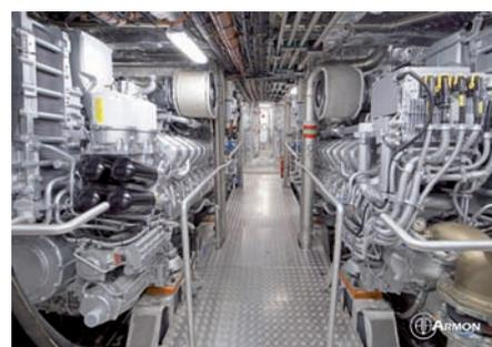
> Cubierta inferior del buque, con la disposición de los motores MTU.
