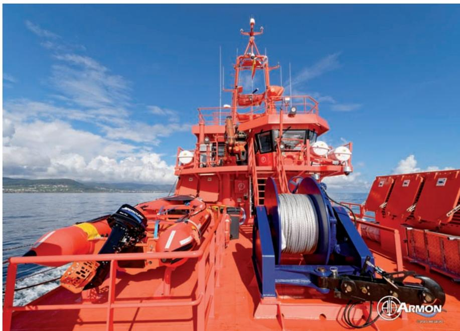
> Cubierta de popa de la “Guardamar Urania”, con la maquinilla de remolque, la embarcación auxiliar de Narwhal y la grúa de Industrias Guerra.
