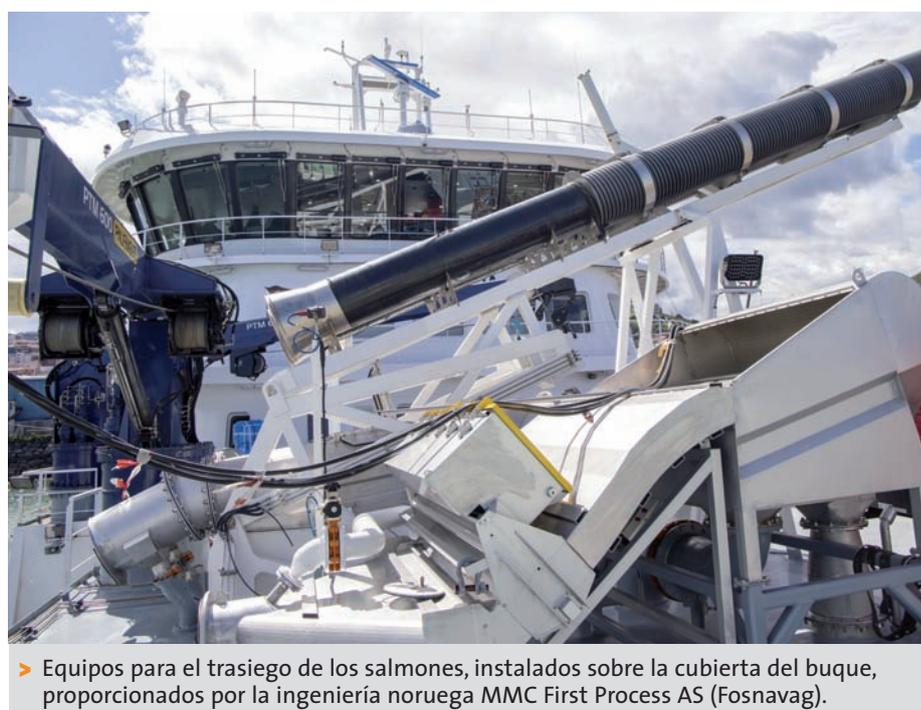
> Equipos para el trasiego de los salmones, instalados sobre la cubierta del buque, proporcionados por la ingeniería noruega MMC First Process AS (Fosnagav).
