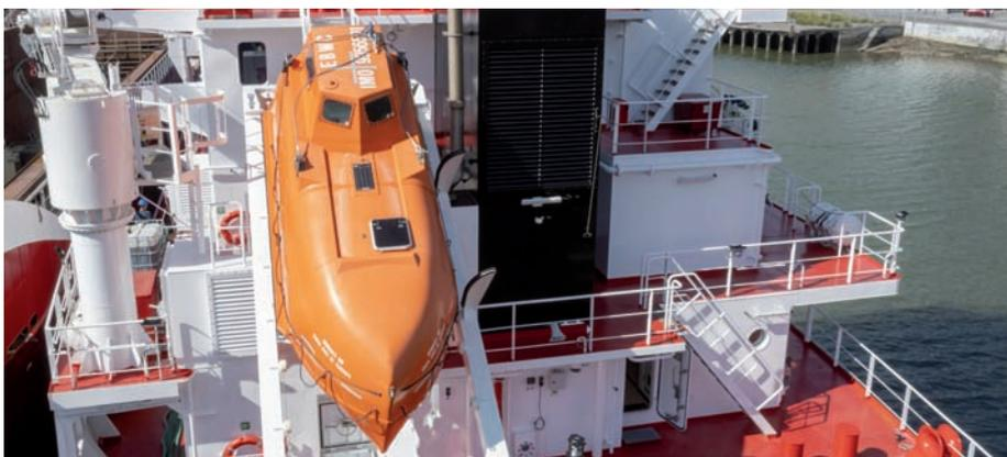
> Popa del granelero con el sistema de embarcación lanzable.
