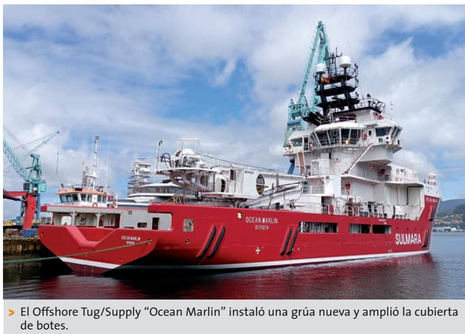
➤ El Offshore Tug/Supply “Ocean Marlin” instaló una grúa nueva y amplió la cubierta de botes.
