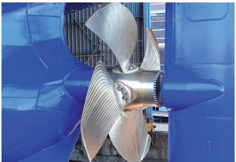
➤ El “Monteraiola”, instala un equipo CP de Schottel con palas de alto rendimiento CLT, diseñada por Sistemar y fundida y mecanizada por Fundilusa.
