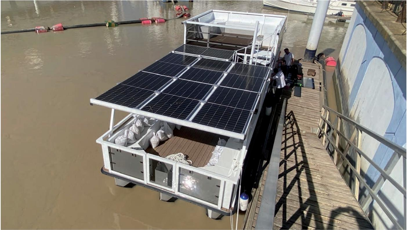
➤ Las 9 placas solares fotovoltaicas instaladas sirven para cargar las baterías.
