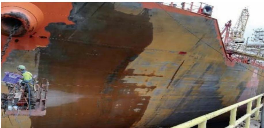
➤ Indasa dispone de bombas de ultraalta presión y diferentes accesorios que le permiten realizar el tratamiento de la superficie de cada parte del casco de una manera más eficiente.
