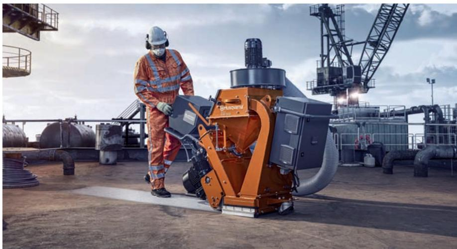
➤ Un adecuado granallado garantiza la adherencia del revestimiento, la pintura o cualquier otro producto que se vaya a aplicar.
