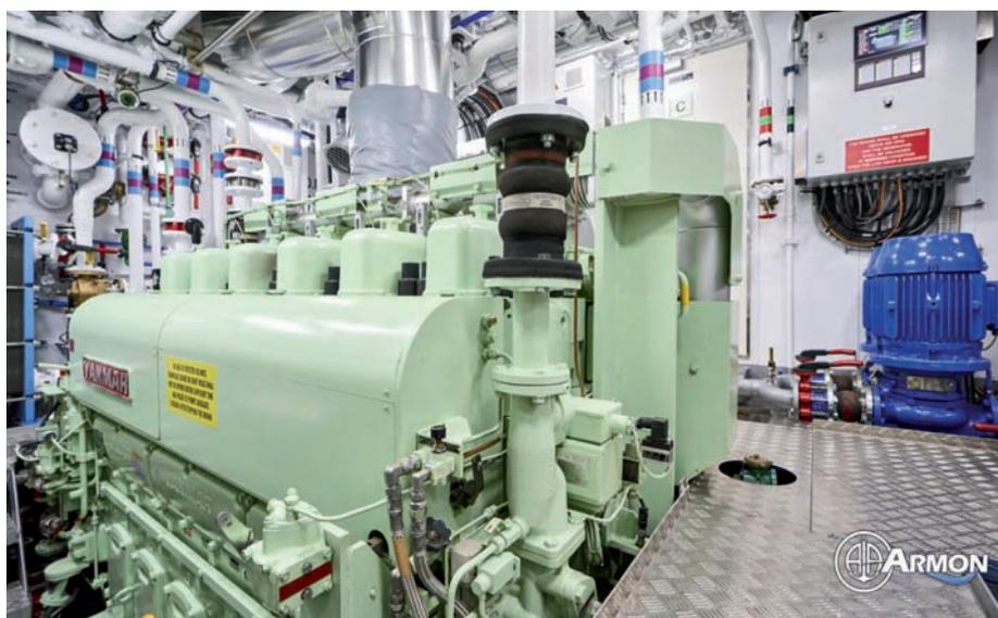
➤ El motor principal dispone de un equipo reductor de emisiones SCR.
