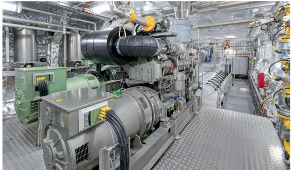
> En cada uno de los patines del "Margarita Salas" va un generador Guascor Energy. En la imagen en primer plano Guascor Energy, modelo SGE 24-SL operando al 100% de LNG y otro generador modelo SF240 de fuel, en esta imagen en segundo plano.
